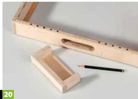
17 Mit einem Stück Sperrholz und einer Quadratleiste legen Sie nun die Ebene der Spielfläche innerhalb des Bandenkastens fest.
