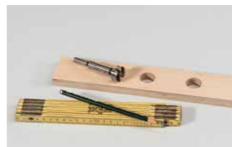
7 In die Kopfbanden müssen die Tore eingelassen werden. Zunächst mit dem Forstnerbohrer im definierten Abstand zwei ...
