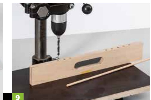
9 In die obere Schnittkante bohren Sie rechts und links vom Tor je fünf Sacklöcher für Holzdübel als Torzähler.
