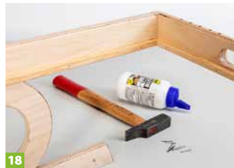
15 Decken Sie die Schraubenköpfe ab, indem Sie Dübelabschnitte in die Löcher leimen.
