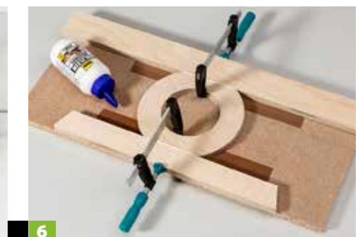
6 Verleimen Sie die Seiten (Fußleiste, Ring und Seitenbände) exakt mittig auf einer mit Paketband beklebten Holzplatte.
