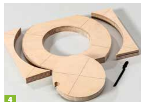
4 Ritzen Sie den Sägeschnitt vor. Zunächst die Mitte, dann den Außenradius mit der Stichsäge (Kurvensägeblatt) zuschneiden.
