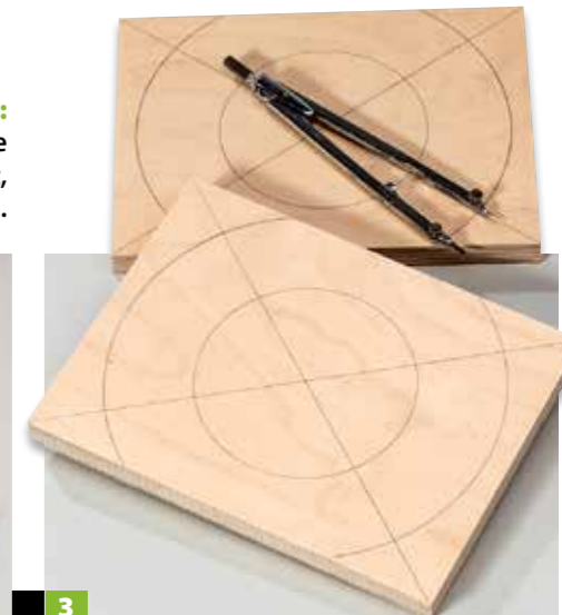
3 Zeichnen Sie den Mittelpunkt und dann die Ringe auf die beiden Multiplexplatten. Oben und unten sind die Ringe flach!
