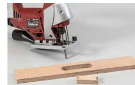
8 ... Löcher bohren und diese dann mit der Stichsäge gerade verbinden.
