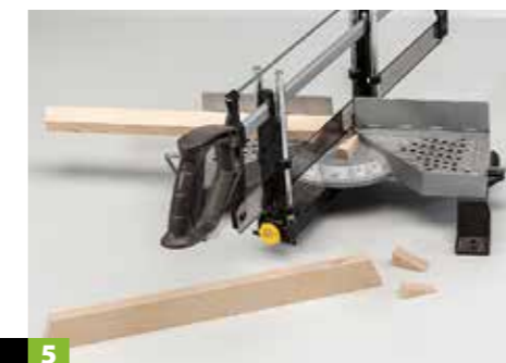
5 Die Fußleisten des Spiels werden schräg zugeschnitten. Am besten gelingt dies mit einer Gestell-Gehrungssäge.
